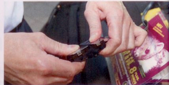
Durch Zusammendrücken der Kontaktplatte wird die Verbindung zum Kabel hergestellt.
