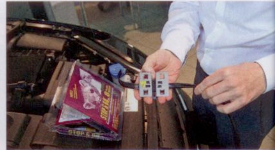
Die Kontaktplatten werden lediglich auf die Leitung des Abwehrgerätes aufgezogen.
