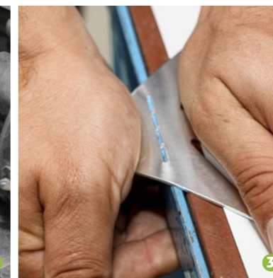
3 An der oberen Ecke des Aluwinkels erleichtert eine Perforation das Biegen ...
