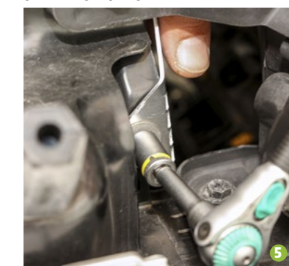
5 Den Befestigungswinkel im Motorraum (z. B. am Kühler) fest verschrauben.
